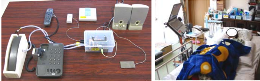
音声を利用して環境制御装置を操作
