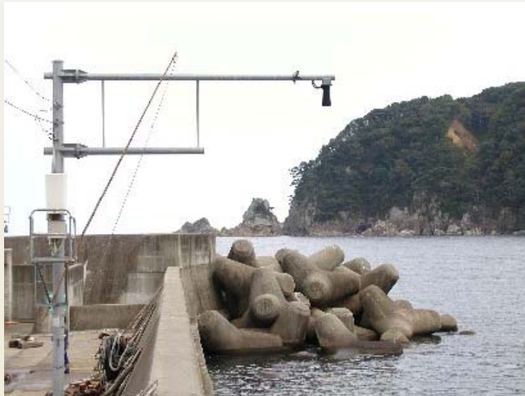
潮位観測用超音波センサー(上)とそのモニター(右上)、津波予測システム(右下)
