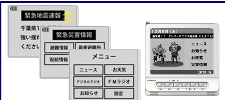
緊急時TMCC信号を用いた自動起動システムを実施し、災害発生時の情報伝達手段として検証する。自治体や公共機関の情報を集約し利用するサービスが実用化されつつあるが、このデータ活用や接続システムを開発・検証し、災害時の有効性や放送運行体制を検証する。
