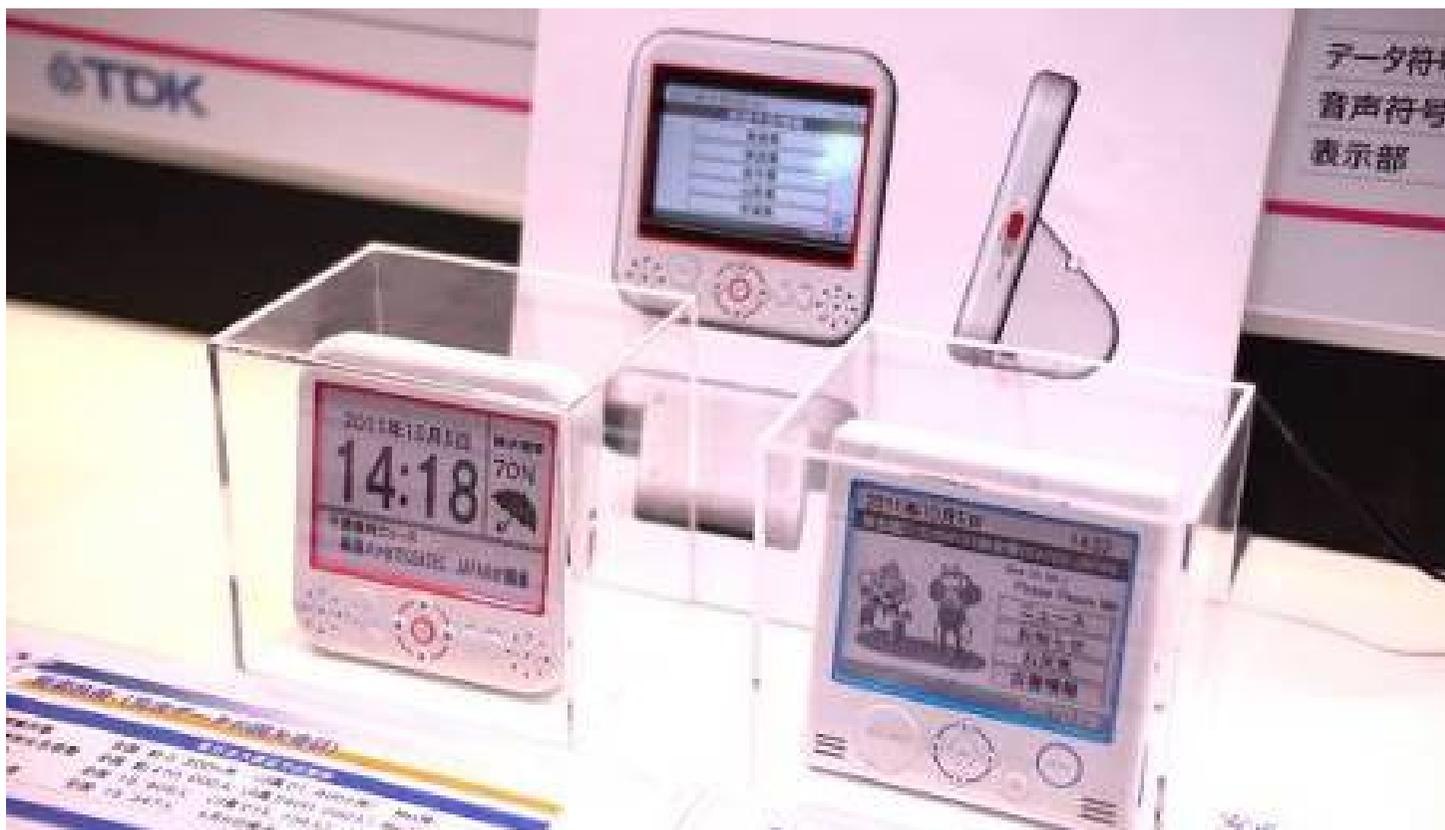
音声放送とデータ放送、蓄積型放送(テキストのみ)に対応。白黒5インチ液晶とした事で長時間のバッテリー駆動が可能。音だけでなく文字で安心安全情報を表示する事で、生活にかかせない端末となることを目指して開発中。
