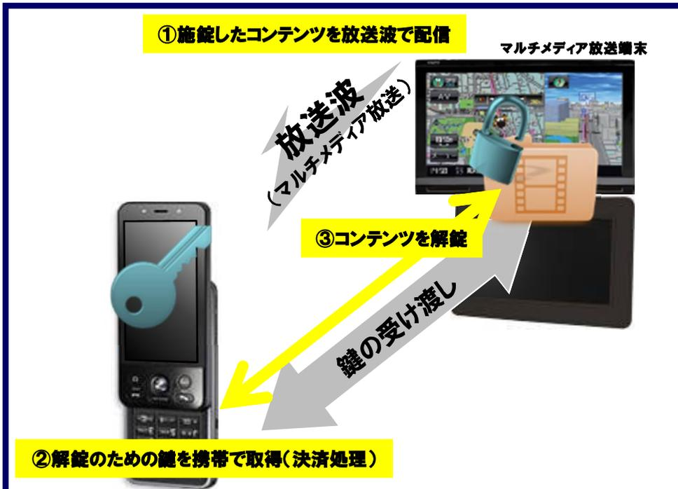
通信機能を持たないフォトフレームやカーナビ型マルチメディア放送端末に対して、携帯電話等で決済し、鍵を取得。マルチメディア放送端末に何らかの手段で渡して鍵を解除するシステムの開発と実証実験を行う。
