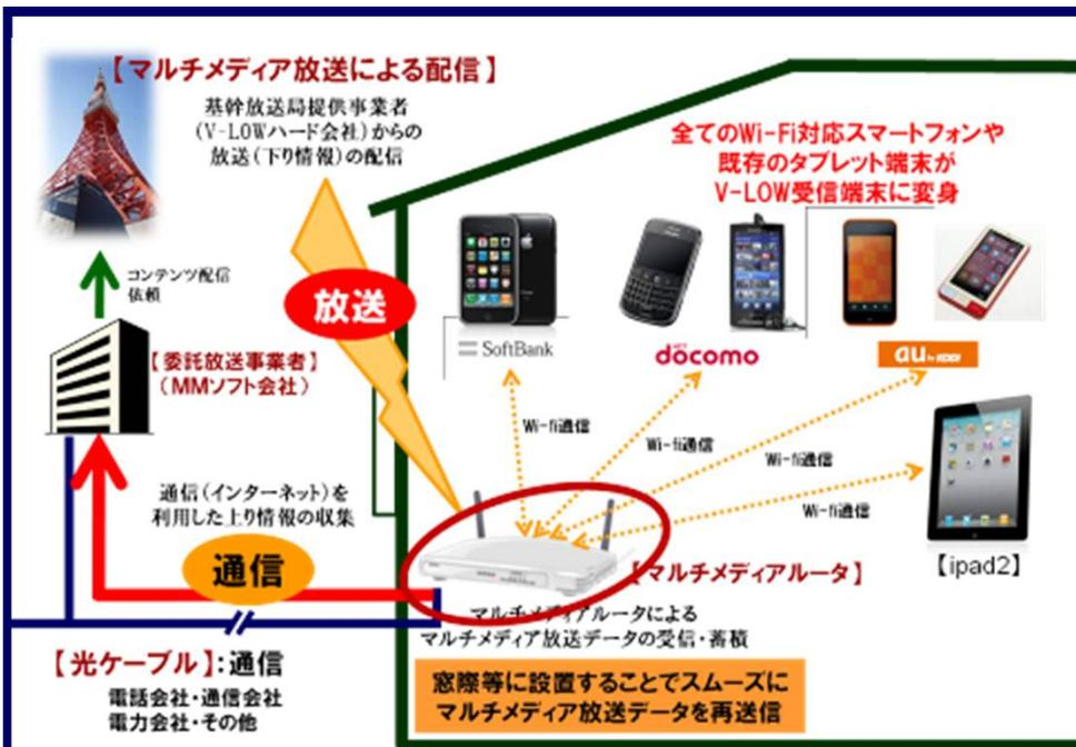
V-LOWマルチメディア放送を受信し、Wi-Fiに変換して家庭内に再送信する「放送波ルーター／サーバー型受信機」の受信環境を用意し、タブレット端末で自由にアプリを開発できる環境の構築と検証を行う。
