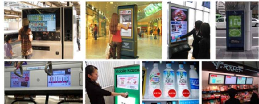
バスや電車のような公共交通の車両の中に設置された移動体サイネージに対し、放送波でリアルタイムにコンテンツを更新することはコスト面で優位性がある。一方、街なか・駅ナカに設置されたサイネージや、自販機の液晶画面を使って、非常時の安全安心情報配信ができるようV-LOWチューナーが入ってれば、通信がダウンしている折であっても安定的に通報することが可能になる。
