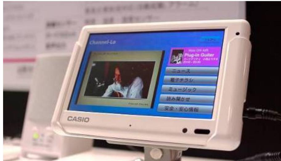
7インチカラー液晶のフォトフレーム風マルチメディア放送端末。フルスペックでV-LOWマルチメディア放送に対応予定で開発中。
