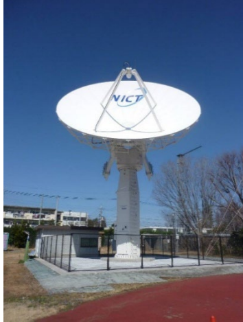
太陽風観測データ受信アンテナ (NASAの衛星からのデータを受信)
