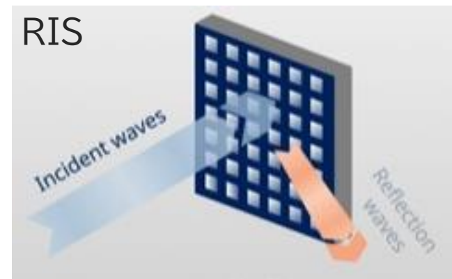
RIS 反射角をフレキシブルにコントロール
