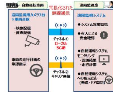
3) 代替ルートを想定したキャリア通信・ローカル5G切替動作の検証
