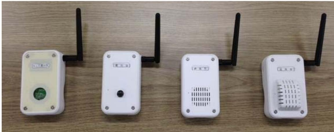
ワイヤレスセンサープラットフォームを利用して作られた簡易型WSPF(フィールドポイント用)、左からセンサ露出型、露出型、通風型A、通風型B
