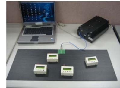
通信と給電を同時に供給可能なワイヤレスセンサネットワーク
