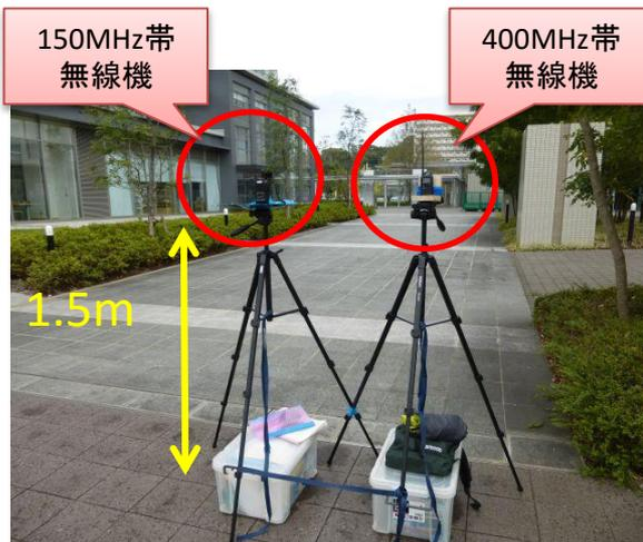
図 試験設置風景(送信局)
