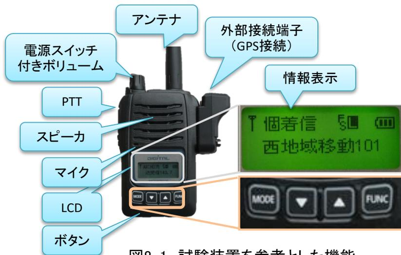
図8-1 試験装置を参考とした機能
