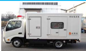
災害対策用 移動電源車
