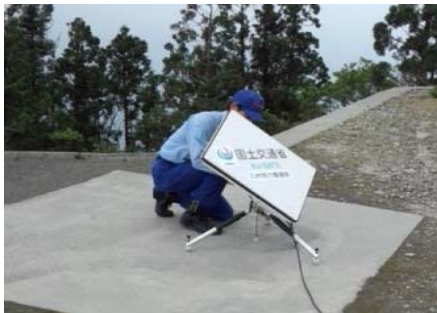
▲Ku-SAT*の設置状況 ※Ku-SAT…衛星小型画像伝送装置
