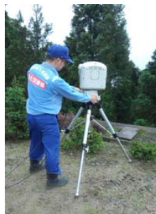
▲口永良部島を監視するカメラの設置状況
