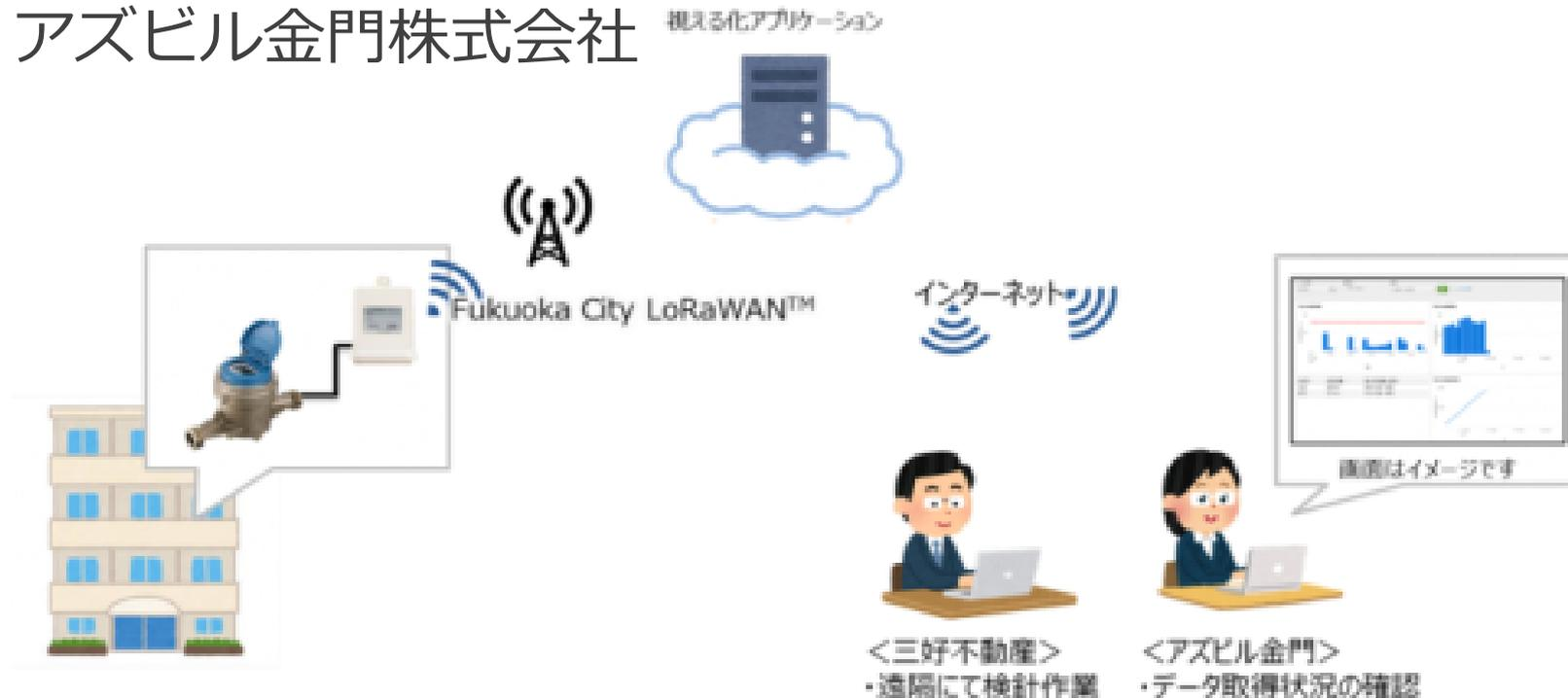
私設のスマート水道メーターからのデータ送信により、水の流量データの見える化，遠隔検針作業，データ取得状況を確認
